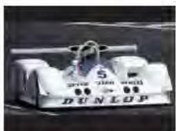
1987年のF3000用ローラT87/50シャシーに、MCS9カウルと無限MF308エンジンを組み合わせた1989年用GCマシン。現車はこの年長谷見昌弘が鈴鹿戦で運転した。ドライバーの星野茂はモントレー・ヒストリック・オートモビルレースやラリージャパンのヒストリック部門にも出場。F1マシンでの走行も趣味で行っている。
