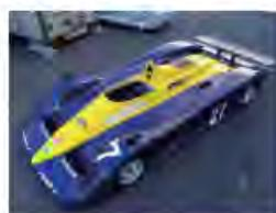
マーチがF3000を元に作ったGC専用車両がGC88。これに自ら開発したボディで参戦することが多かった岡本金幸が作ったスペシャルボディを組み合わせ、DFVエンジンを載せたのがこの個体。最後のGCレースとなった1989年最終戦のみに登場した。ドライバーの田中裕司は、様々なヒストリックカーレースに参戦している。
